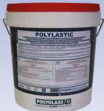
**POLYLASTIC** è una membrana monocomponente di tipo elastomerica bituminosa in emulsione acquosa pronta all'uso, ottenuta dal mix di speciali bitumi, particolari resine elastomeriche sintetiche e filler ad elevata dispersione.
